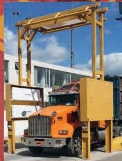
**DETECTORES DE RADIACIÓN TIPO PÓRTICO PARA ENTRADAS-SALIDAS**
