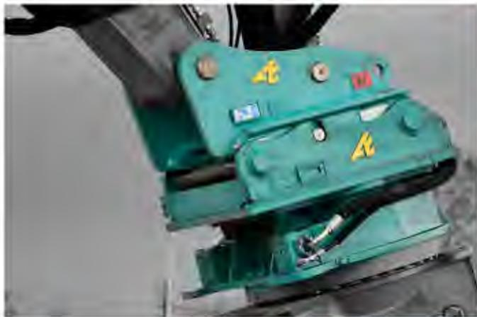
Enganche rápido **AIO All In One** con conexiones automáticas.
