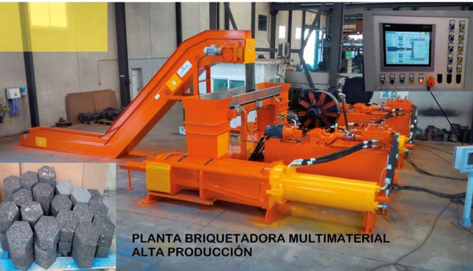
**PLANTA BRIQUETADORA MULTIMATERIAL
