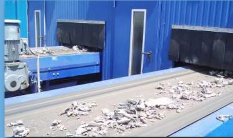
La tarea principal es la selección manual de los residuos o los impropios que pasan por una cinta de transporte. Mediante movimientos de manos y brazos se separan distintos tipos de materiales que se depositan en contenedores específicos o tolvas. Los materiales manipulados en la cinta tienen un peso inferior a 2 Kg.
