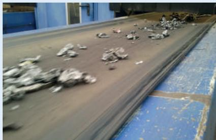
**Materiales seleccionados en cinta de transporte con peso inferior a los 2Kg.**
