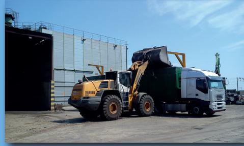
La tarea principal del maquinista es la conducción y manejo de los equipos de carga o manipulación, como por ejemplo grúa torre, retroexcavadora con pulpo o pala cargadora. Se pueden realizar tareas secundarias como el manejo de maquinaria fija, la limpieza, recogida y clasificación de piezas pequeñas.
