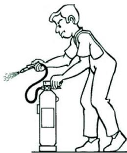
3. Presionar la palanca de la cabeza del extintor y en caso de que exista apretar la palanca de la boquilla realizando una pequeña descarga de comprobación.
