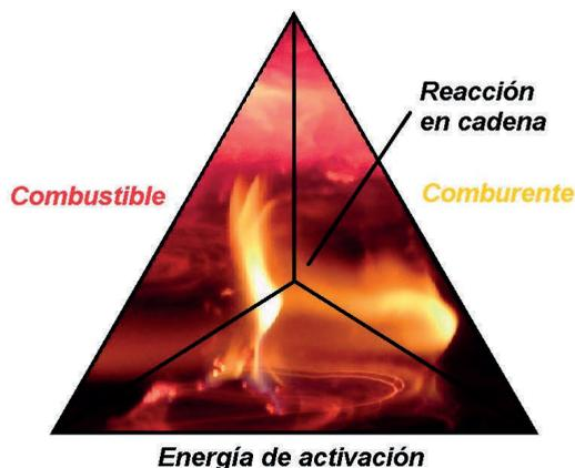
Si se elimina uno de los factores o se disminuye su intensidad suficientemente, el fuego se extinguirá. Según el factor que se pretenda eliminar o disminuir el procedimiento o método de extinción recibe el nombre de:
