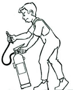
2. Asir la boquilla de la manguera del extintor y comprobar, en caso que exista, que la válvula o disco de seguridad (V) está en posición sin riesgo para el usuario. Sacar el pasador de seguridad tirando de su anilla.
