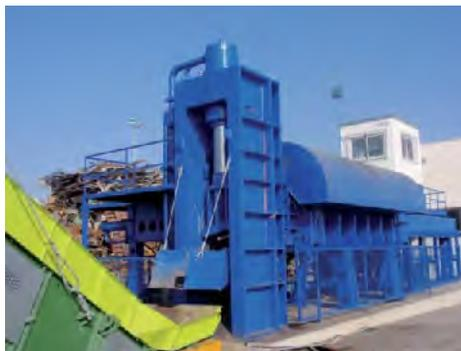
El residuo se deposita por la boca del compactador, donde un plato prensor, que simplemente es una plancha metálica, empujará el residuo hacia dentro gracias al motor. El residuo se irá introduciendo en la caja de hierro, hasta que ocupe todo su interior. Una vez lleno, todo el residuo empezará a comprimirse, por la fuerza de presión que ejerce la máquina.
