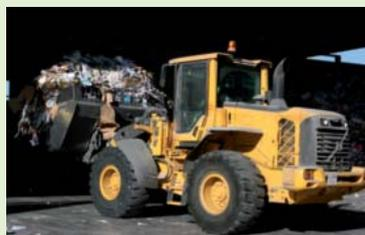
Se denomina **pala cargadora**, cargadora de pala frontal, pala cargadora frontal o cargador, a la pala mecánica compuesta de un tractor sobre orugas o neumáticos, equipado de una cuchara cuyo movimiento de elevación se logra mediante dos brazos articulados.
