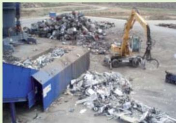
El **tritador** procesa un material de forma que produce dicho material con trozos de un tamaño menor al tamaño original. Rompe y reduce el residuo en una serie de piezas más pequeñas o compactas.
